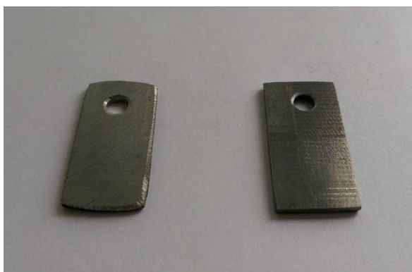
Фиг. 1. Моделни образци от стомана (ляво) и сферографитен чугун (дясно)
