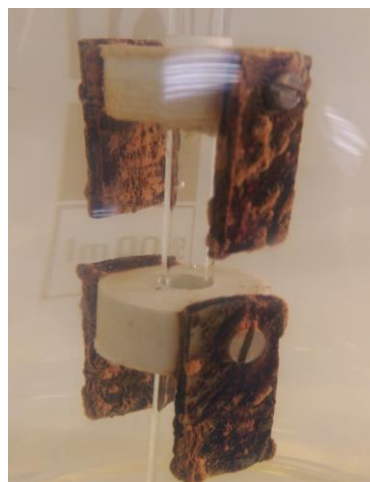
Фиг. 5. Корозия на чугуnenи (горе) и стоманени (долу) моделни образци в обработена вода с \text{CO}_2 и \text{Na}_2\text{SiO}_3 при \text{pH} \approx 7 ; \text{SiO}_3^{2-} = 84,5 \text{ mg/L} , A = 3,0 \text{ meq/L} . Образуване на \text{Fe}_3\text{O}_4 (магнетит)
