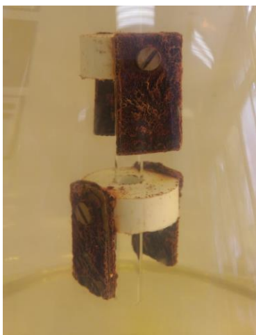
Фиг. 4. Корозия на чугуnenи (горе) и стоманени (долу) моделни образци в обработена вода с \text{CO}_2 и \text{Na}_2\text{SiO}_3 при \text{pH} \approx 7 ; \text{SiO}_3^{2-} = 54,5 \text{ mg/L} , A = 1,0 \text{ meq/L} . Образуване на \text{Fe}_3\text{O}_4 (магнетит)
