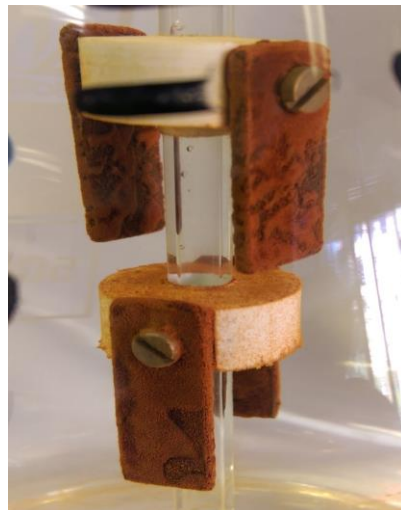
Фиг. 7. Корозия на чугунени (горе) и стоманени (долу) моделни образци в обработена вода с \text{CO}_2 и \text{NaCO}_3 при \text{pH} \approx 7 ; \text{Ca}^{2+} = 9 \text{ mg/L} , A = 3,0 \text{ meq/L}
