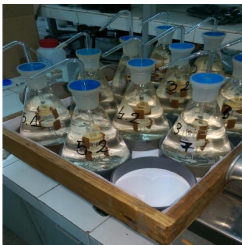
Фиг. 2. Инсталация за корозионни изпитвания
