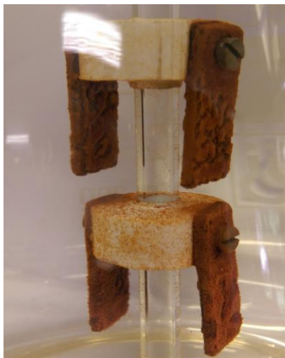
Фиг. 6. Корозия на чугунени (горе) и стоманени (долу) моделни образци в обработена вода с \text{CO}_2 и \text{NaCO}_3 при \text{pH} \approx 7 ; \text{Ca}^{2+} = 9 \text{ mg/L} , A = 1,5 \text{ meq/L}
