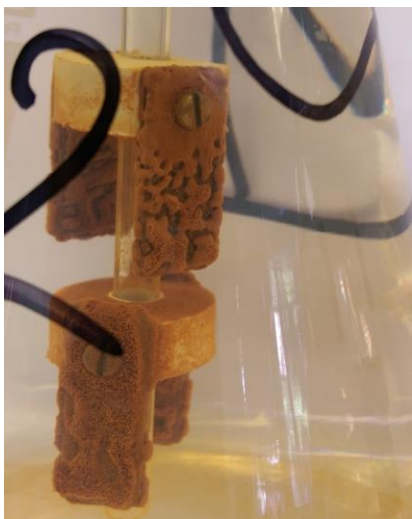
Фиг. 9. Корозия на чугуnenи (горе) и стоманени (долу) моделни образци в необработена вода pH ~ 7,4; Ca^{2+} = 9 \text{ mg/L} , A = 0,65 \text{ meq/L}
