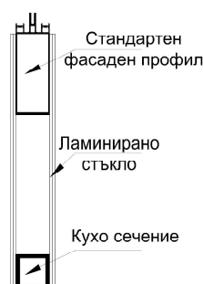
Фиг. 7. Комбинирано затворено сечение от алуминий и стъкло
